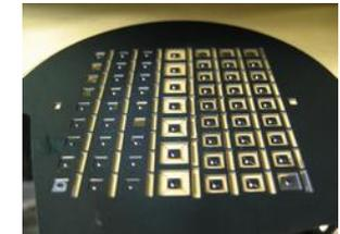
容量型3軸加速度センサの試作例
