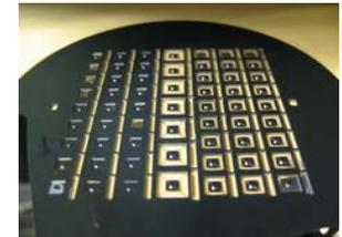
容量型3軸加速度センサの試作例
