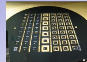
容量型3軸加速度センサの試作例
